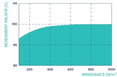
Puissance de modules typique sous des conditions de rayonnements faibles par rapport aux conditions STC (25 °C, 1000 W/m<sup>2</sup>).
